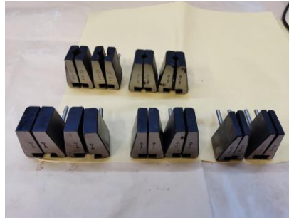
Round jaw(mm): \Phi 4- \Phi 9, \Phi 9- \Phi 14, \Phi 14- \Phi 20 Flatjaw:0-7,7-14,14-20
